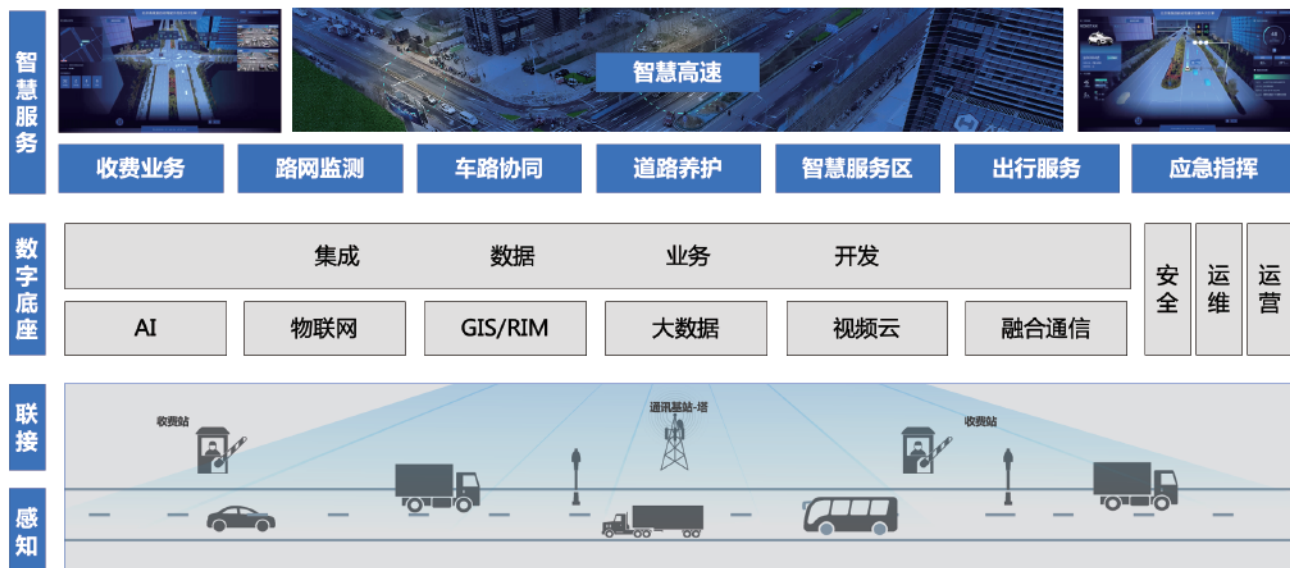
图 5.3 智慧高速总体系统架构
